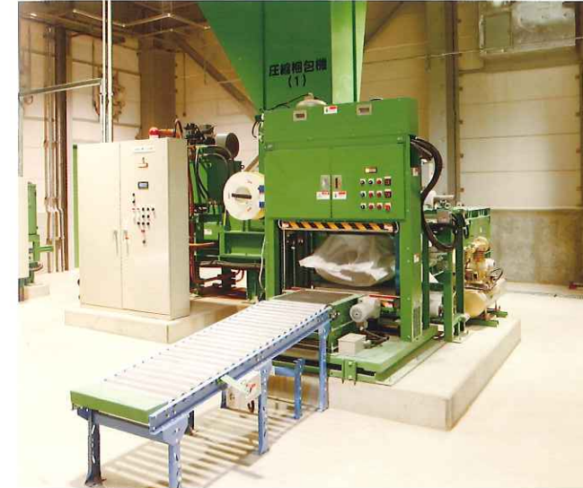
⑦圧縮梱包機(1) 選別されたプラスチック製容器包装を圧縮梱包します。
