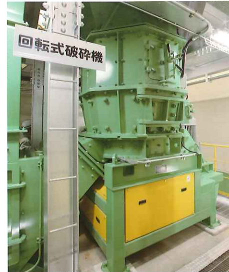
②回転式破砕機 不燃性大型ごみを回転するハンマーで細かく砕きます。
