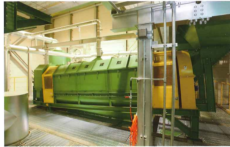
④粒度選別機 回転するふるいで不燃物と可燃物・アルミに選別します。
