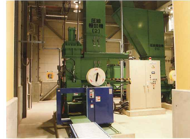
⑧圧縮梱包機(2) 選別された紙製容器包装、ペットボトルを圧縮梱包します。
