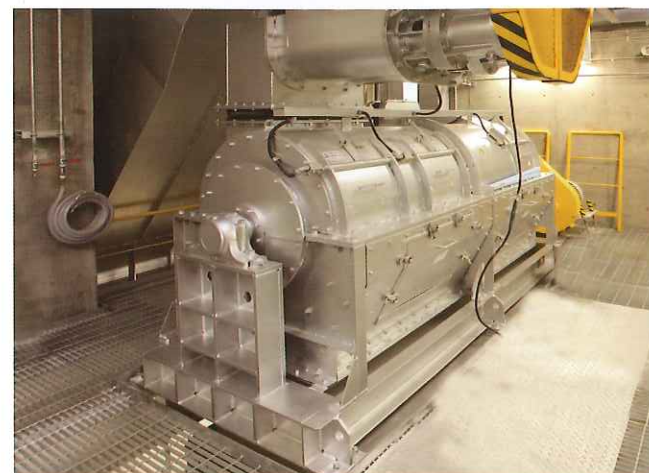
③破碎選別装置 破碎選別処理され、バイオガス化に適した発酵対象ごみとそれ以外に選別されます。
