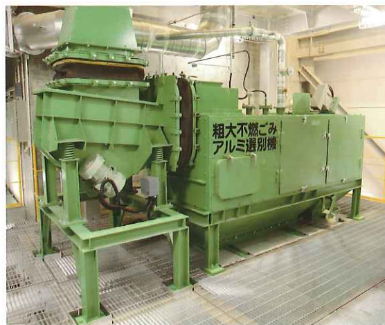
⑤アルミ選別機 磁石の力を使ってアルミを回収します。
