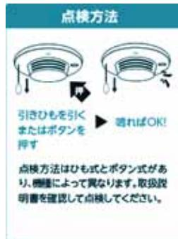
平成18年の住宅用火災警報器の設置義務化から10年が経過しました。住宅用火災警報器は古くなると電子部品の寿命や電池切れなどで、火災を感知しなくなることがあります。いざという時、鳴らし声で警報器に付いている紐を引っぱったりボタンを押したりして点検し、正常に作動しない場合は交換しましょう。
